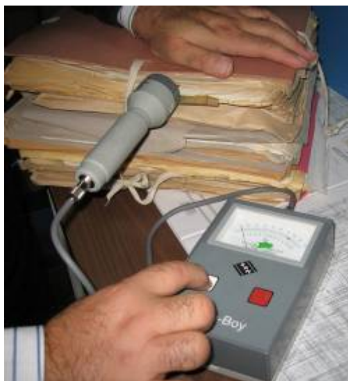
Figura 5: misura dell'umidità della carta
